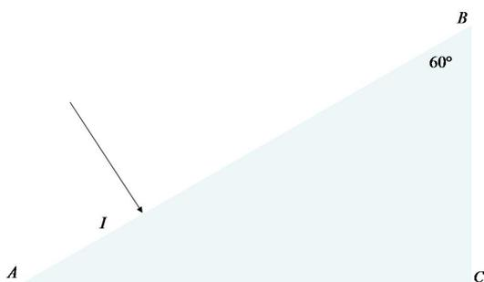
Un rayon lumineux rentre à la perpendiculaire d'un prisme par le côté AB. Il poursuit alors tout droit dans le prisme, puis se réfléchit successivement sur les côtés AC et AB avant de ressortir par la face BC. Déterminer la direction du rayon lorsqu'il ressort du prisme. On rappelle la loi de la réflexion : à chaque "rebond", l'angle d'incidence est égal à l'angle de réflexion.
