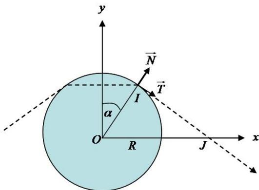
Un rayon lumineux parvient sur une lentille boule de rayon  $R$  et ressort au point  $I$  tangentielllement à cette boule. Les vecteurs  $\vec{T}$  et  $\vec{N}$  sont les vecteurs unitaires respectivement tangent et perpendiculaire à la boule, au point  $I$ .
