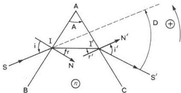
Le schéma ci-dessus représente la trajectoire d'un rayon lumineux à travers un prisme. Les vecteurs  $\vec{N}$  et  $\vec{N}'$  sont les vecteurs perpendiculaires (ou *normaux*) respec-
